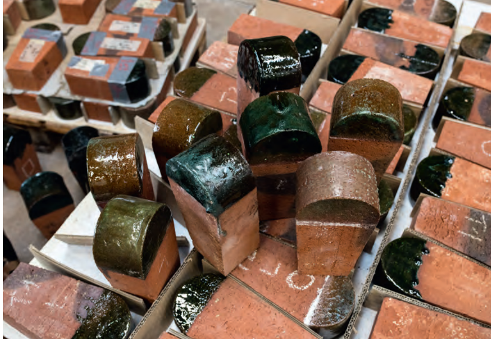
De nye, håndlavede sten før afgang fra teglværket. Kun den synlige del af de tungeformede sten er glaseret for at sikre at mørtlen binder stenene.
